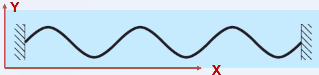
Una cuerda tensa que vibra a baja amplitud
