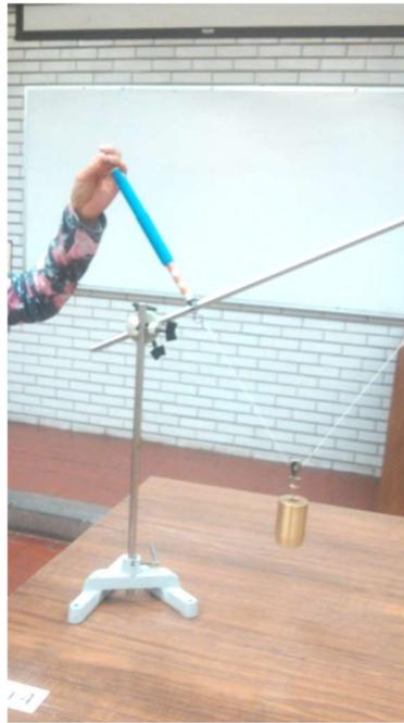
*Figura 3 Forma de medir tensiones en un hilo.*
