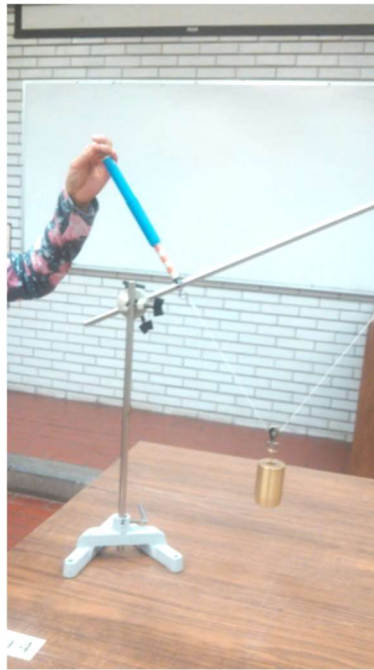
Figura 3 Forma de medir tensiones en un hilo.
