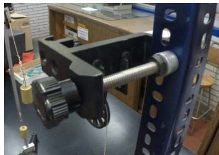
Figura 1 Una abrazadera universal con una polea de plástico, sujeta al bastidor.
