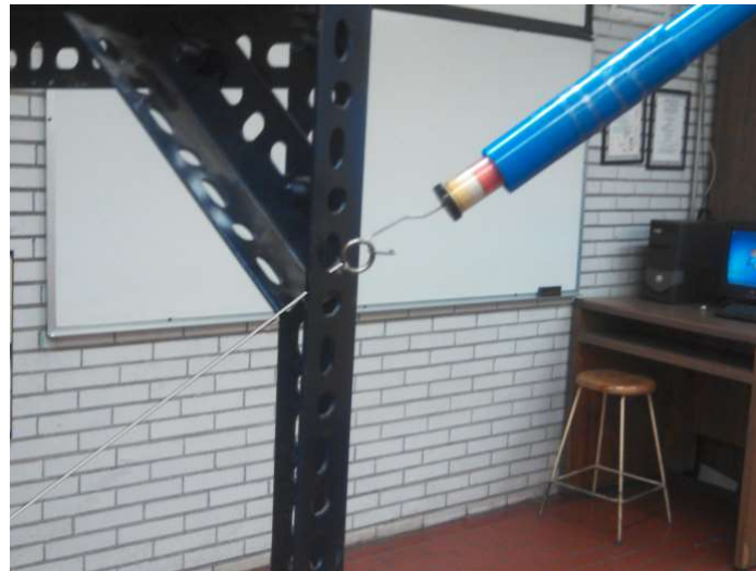
Figura 8 Medición de la tensión de la cuerda colocada en el agujero del bastidor metálico.
