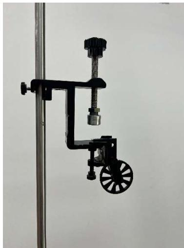
*Figura 2 Abrazadera universal con una polea de plástico, sujeta a la varilla vertical con base.*
