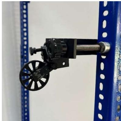
*Figura 1 Una abrazadera universal con una polea de plástico, sujeta al bastidor.*
