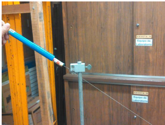
Figura 7 Medición de la tensión de la cuerda enganchada al bloque de sujeción.
