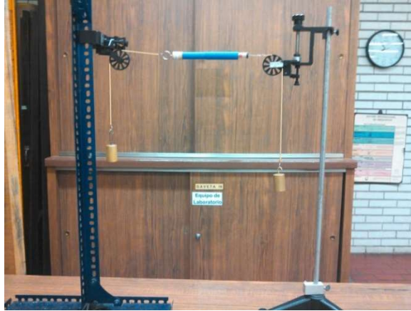
Figura 3 Dinamómetro colocado entre las poleas, con cuerdas y cilindros de 0.2 kg.
