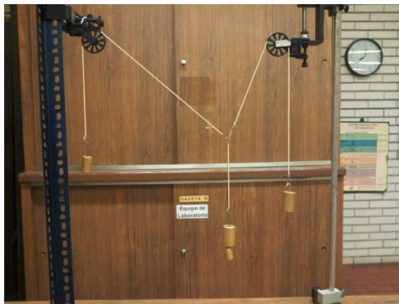
Figura 4 Arreglo de dos cuerdas con un cilindro de 0.2 kg, uno de 0.1 kg y los otros dos de 0.2 y 0.05 kg.
