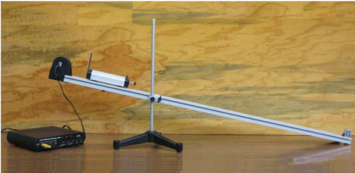
*Figura 1 Rampa de aluminio con sensor de movimiento conectado a la interfaz Science Workshop 750.*
