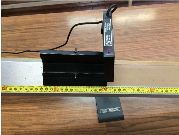
*Figura 8 Compuerta electrónica con el carro en la posición en que el led indicador está a punto de encenderse.*
