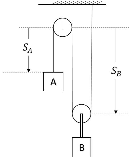
Si se sabe que el cuerpo  $A$  baja con una velocidad de  $2 \text{ m/s}$  aumentando a razón de  $1 \text{ m/s}^2$ . Determine la velocidad y aceleración de  $B$  en el mismo instante.
