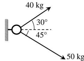
Una manera sencilla de determinar que el ángulo interior conocido es de 105°, es trazar líneas auxiliares horizontales en los vértices del triángulo, como se muestra en la figura. El ángulo que forma línea de acción de la fuerza de 50 kg con cualquier horizontal es de 45°, mientras el que forma la otra es de 30°. Como fácilmente se deduce,  $180 - 45 - 30 = 105$ .
