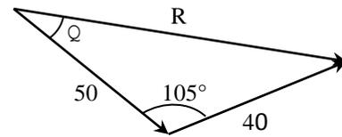
Tenemos, pues, un triángulo del que conocemos dos lados y el ángulo que forman entre sí. Conforme al teorema (o ley) de los cosenos (ver apéndice, 3),
