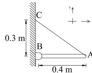
8. El cable que sujeta el poste de la figura sufre una tensión de 210 lb. Diga qué vector representa la fuerza que el cable ejerce sobre el extremo A del poste.
