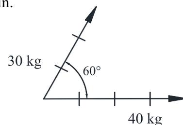
modo que 1 cm corresponda a 10 kg. Dibujamos un paralelogramo, tomando esas fuerzas como lados, dibujamos la diagonal y medimos su longitud y el ángulo que forma con la horizontal. Como mide alrededor de 6.1 cm, entonces la resultante es de 61 kg y su dirección forma un ángulo de 25° con la horizontal.
