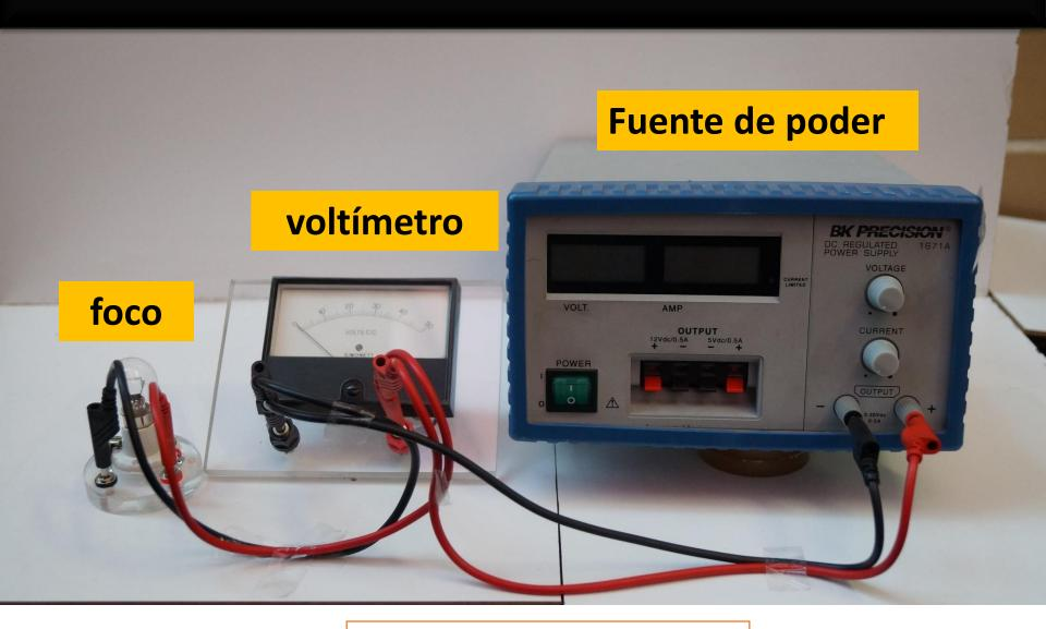
Figura 1. Dispositivo experimental.
