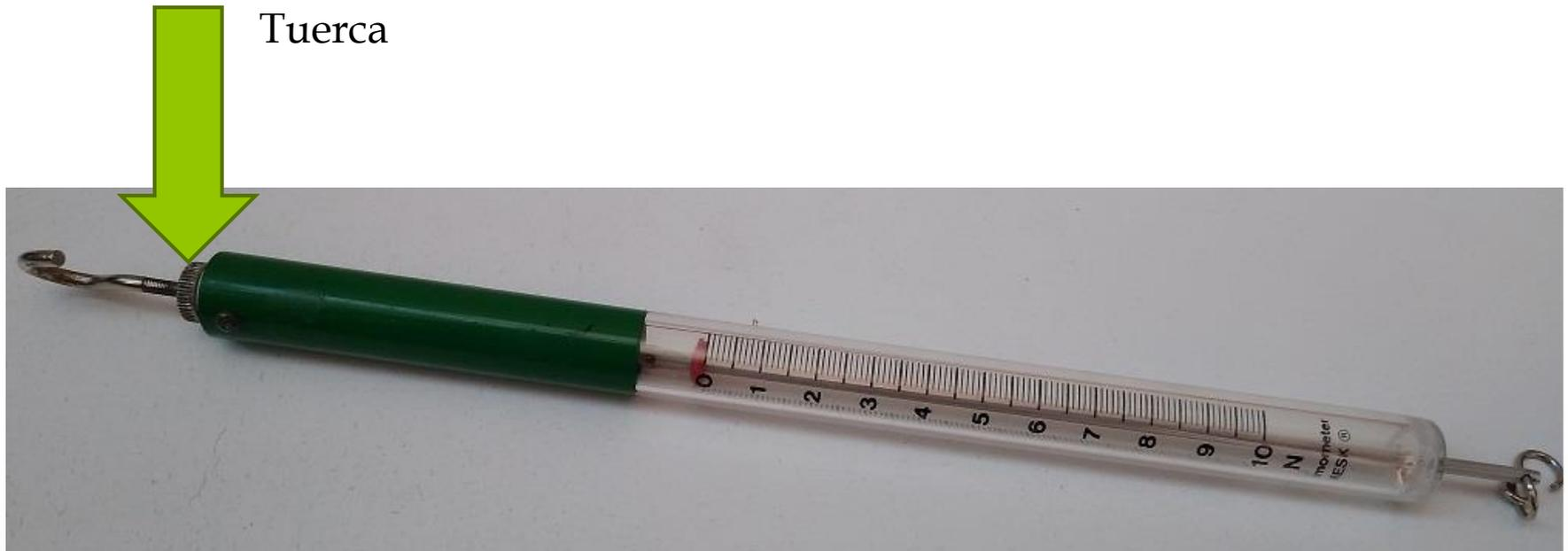
Este puede realizarse al aflojar la tuerca superior y girar el gancho del soporte hasta que la parte media del indicador marque cero, una vez hecho esto apretar la tuerca superior para asegurar el **ajuste a cero**.
