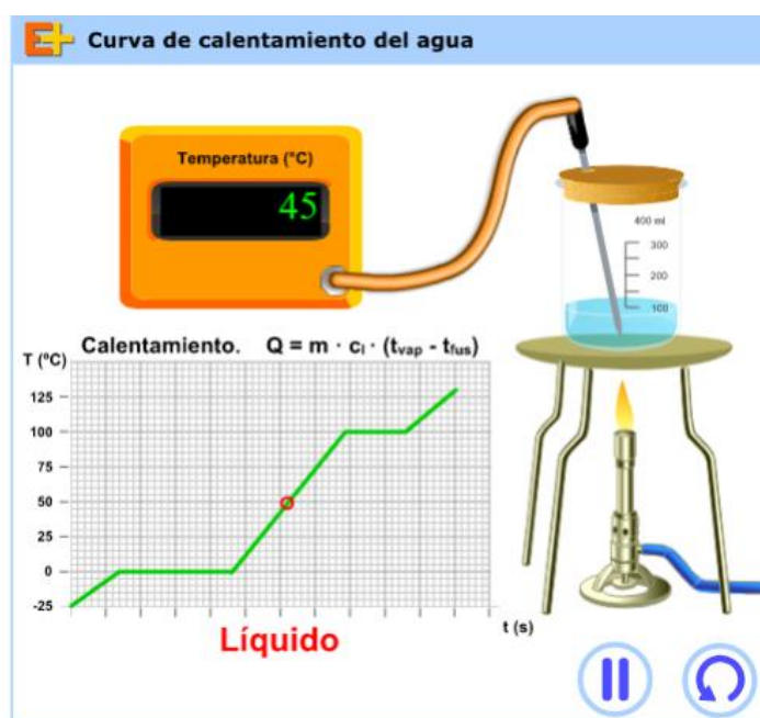
Figura 5.3. Pantalla del simulador de curva de calentamiento.
