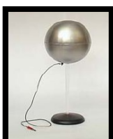
Foto 2. Esfera de descarga.
