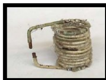
Foto 7. Bobina sin aislamiento.
