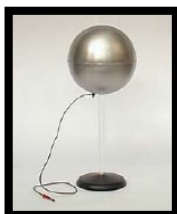
Foto2. Esfera de descarga.
