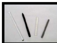
Foto 7. Barras de vidrio, hule, acrílico y policloruro de vinilo.
