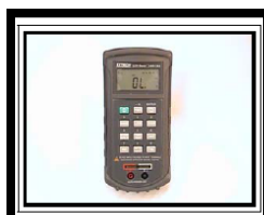
Foto 2. Puente de impedancias.
