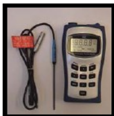
Foto 1. Teslámetro digital (Para uso del profesor).
