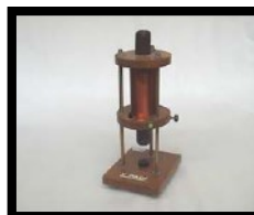
Foto 7. Solenoides de 800 vueltas y núcleo recto de acero.
