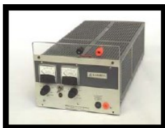
Foto 5. Fuente de poder de 0-20 [V] 0-10 [A] de cd.
