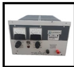
Foto 3. Fuente de diferencia de potencial continua.
