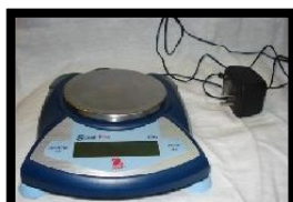
Foto 6. Balanza de 400 [g] y resolución de 0.01 [g].
