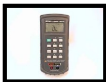
Foto 2. Puente de impedancias.
