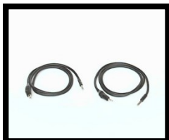
Foto 9. Dos cables para diferencias de potencial elevadas.
