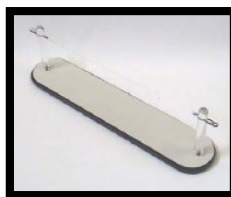
Foto 3. Soporte con alambre de níquel.
