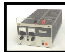
Foto 8. Fuente de poder de 0-20 [V] 0-10 [A] de cd.
