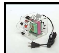
Foto 16. Transformador reductor (127 [V] a 10 [V] de c.a.).
