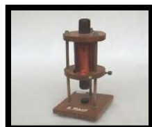
Foto 6. Solenoide de 800 vueltas y núcleo recto de acero.
