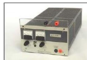
Foto 8. Fuente de poder de 0-20 [V] 0-10 [A] de cd.
