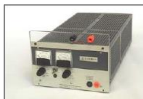
Foto 7. Fuente de poder de 0- 20 [V] 0-10 [A] de cd.
