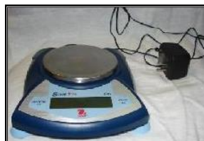
Foto 6. Balanza de 400 [g] y resolución de 0.01 [g].
