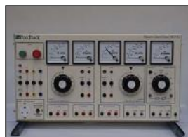
Foto 11. Módulo feedback Machine control panel MCP182.
