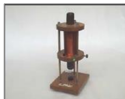
Foto 7. Solenoides de 800 vueltas y núcleo recto de acero.
