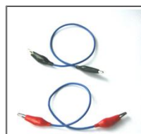
Foto 7. Cables para conexión (proporcionados por los alumnos).
