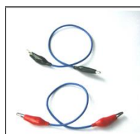
Foto 10. Cables para conexión (proporcionados por los alumnos).
