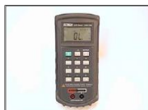
Foto 2. Puente de impedancias
