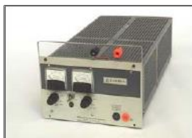
Foto 5. Fuente de poder de 0- 20 [V] 0-10 [A] de cd.
