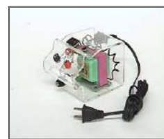
Foto 16. Transformador reductor (127 [V] a 10 [V] de c.a).
