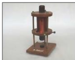
Foto 6. Solenoide de 800 vueltas y núcleo recto de acero.
