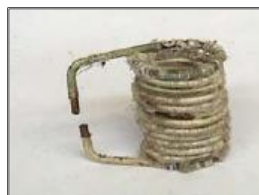
Foto 7. Bobina sin aislamiento.
