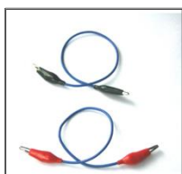
Foto 5. Cables para conexión (proporcionados por los alumnos).
