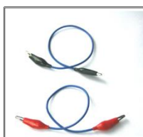
Foto 5. Cables para conexión (proporcionados por los alumnos).
