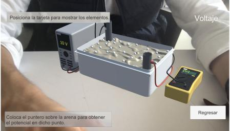
11. Una vez desplegados los elementos, el usuario podrá dar clic con su dedo sobre las esferas blancas que se encuentran en la arena. La selección con el dedo simulará la terminal positiva del multímetro para obtener la medición del potencial en dicho punto, la cual se mostrará en la pantalla del mismo así como en la parte superior derecha. De esta forma, el usuario realizará un esquema sobre la descripción del fenómeno mostrado.
