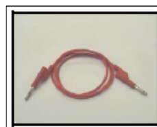
Foto 7. Cables banana- banana y cables caimán- banana.
