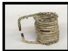
Foto 7. Bobina sin aislamiento.
