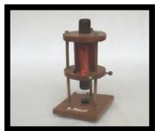
Foto 6. Solenoide de 800 vueltas y núcleo recto de acero.
