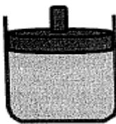
2. Un dispositivo de cilindro-émbolo contiene inicialmente 1.4 [kg] de agua líquida saturada a 200 [°C]. Se transmite calor al agua, hasta que se alcanza 10 veces el volumen inicial y el vapor sólo contiene vapor saturado. Determine la temperatura final del proceso y el cambio de energía interna del agua.
