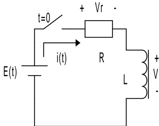
Vamos a ver el comportamiento de la corriente a través de un inductor cuya inductancia es  $L$ , cuando esta corriente eléctrica es obligada a pasar por una resistencia de valor  $R$ . Para tal propósito se tiene un circuito en el cual un inductor totalmente descargado, está conectado en serie con una resistencia, a las terminales de una fuente de voltaje constante  $E$ .
