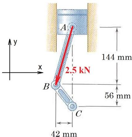
Para simplificar la resolución de ambos casos, conviene descomponer la fuerza de 2.5 kN en una componente horizontal y otra vertical, para la cual se obtiene su vector unitario, considerando el punto C como el origen:
