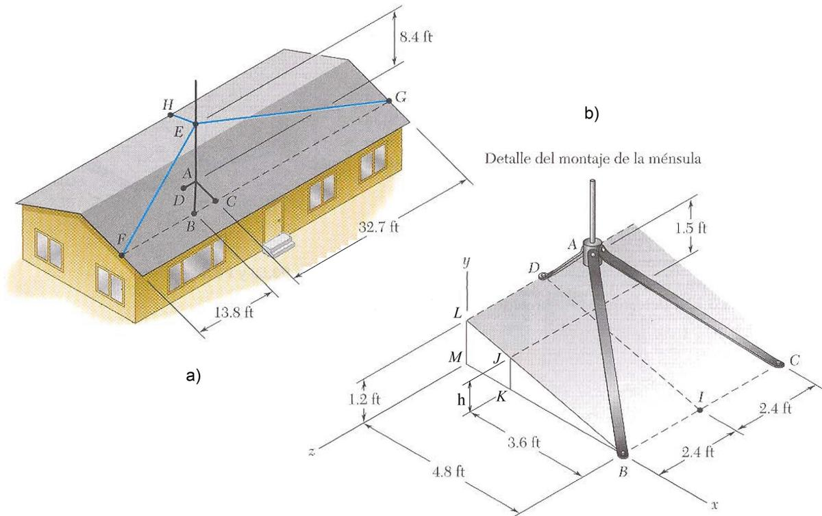
Para obtener la coordenada  $y$  del punto  $E$ , como se observa en la figura a), el punto  $E$  se encuentra 8.4 ft arriba del punto  $A$ . Por otro lado, en la figura b) se puede verificar que el punto  $A$  se ubica a 1.5 ft del techo de la casa y, que a su vez, está elevado una altura  $h$  respecto al plano  $xz$ .
