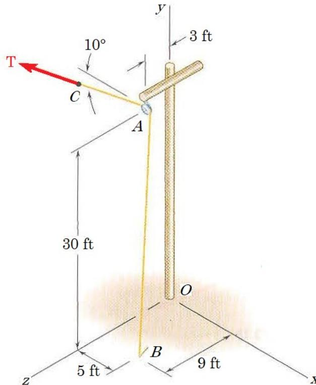
Primero se obtienen las representaciones vectoriales de las fuerzas de tensión en los segmentos de cuerda  $\overline{AB}$  y  $\overline{AC}$  para las cuales se obtienen primero sus vectores unitarios.
