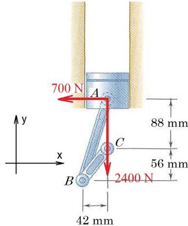
Nuevamente se aplica el teorema de Varignon, recordando que la componente horizontal tiende a hacer girar a la biela en sentido antihorario, por tanto positivo, y la componente vertical también en este caso produce un momento cero debido a que su línea de acción pasa por C:
