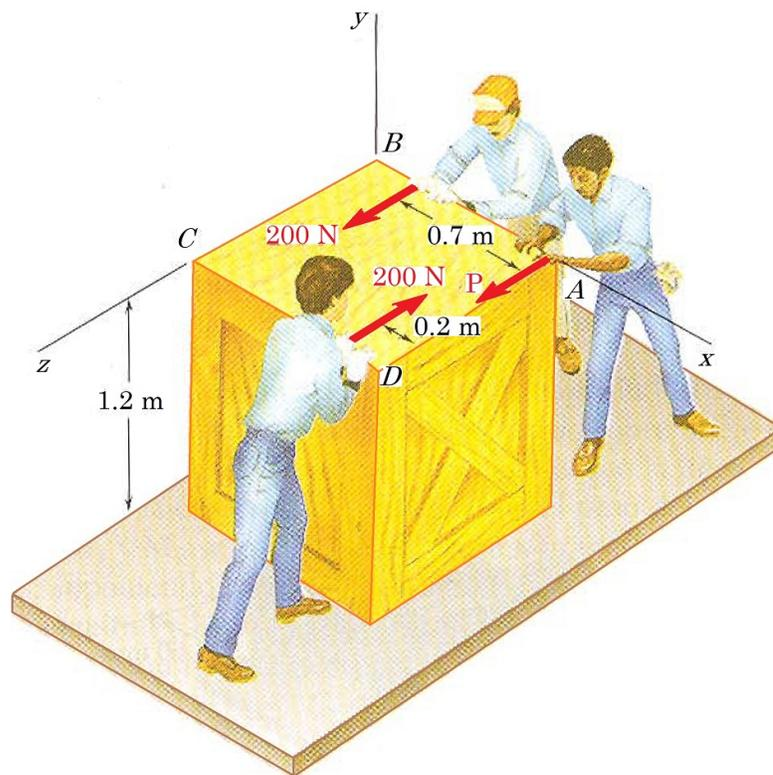
**a) Si  $P = 240$  N, reemplace las tres fuerzas con un sistema fuerza-par equivalente en A**
