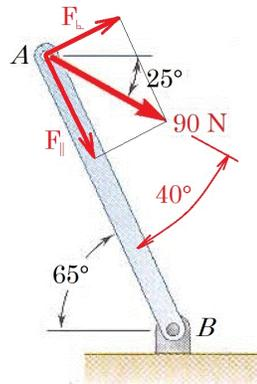
Al descomponer la fuerza de 90 N en una componente a lo largo de AB,  $F_{\parallel}$ , y otra perpendicular a AB,  $F_{\perp}$ , resulta:
