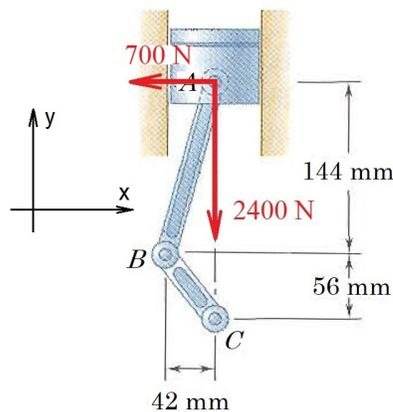
Finalmente, se aplica el teorema de Varignon para calcular la magnitud del momento de la fuerza de 2.5 kN respecto a C. El momento de la componente horizontal es positivo, debido a que la tendencia a hacer girar la biela es en sentido antihorario; para la componente vertical, el momento es cero, debido a que su línea de acción pasa por C:
