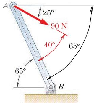
Dado el teorema de que los ángulos alternos internos entre paralelas son iguales, el ángulo que forma la barra AB con la horizontal en B es igual al que forma con la horizontal en A, tal como se indica en la figura anterior.
