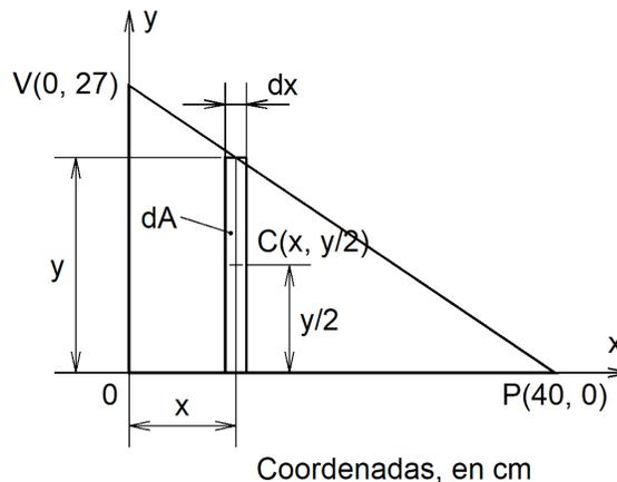
Con base en el fundamento de equivalencia de sistemas de fuerzas, se demostró que para obtener las coordenadas del centro de gravedad de un cuerpo tabular, cuya densidad es  $\rho$ , la constante de la aceleración del campo gravitatorio terrestre es  $\mathbf{g}$  y el espesor de la tabla es  $e$ , las expresiones son:
