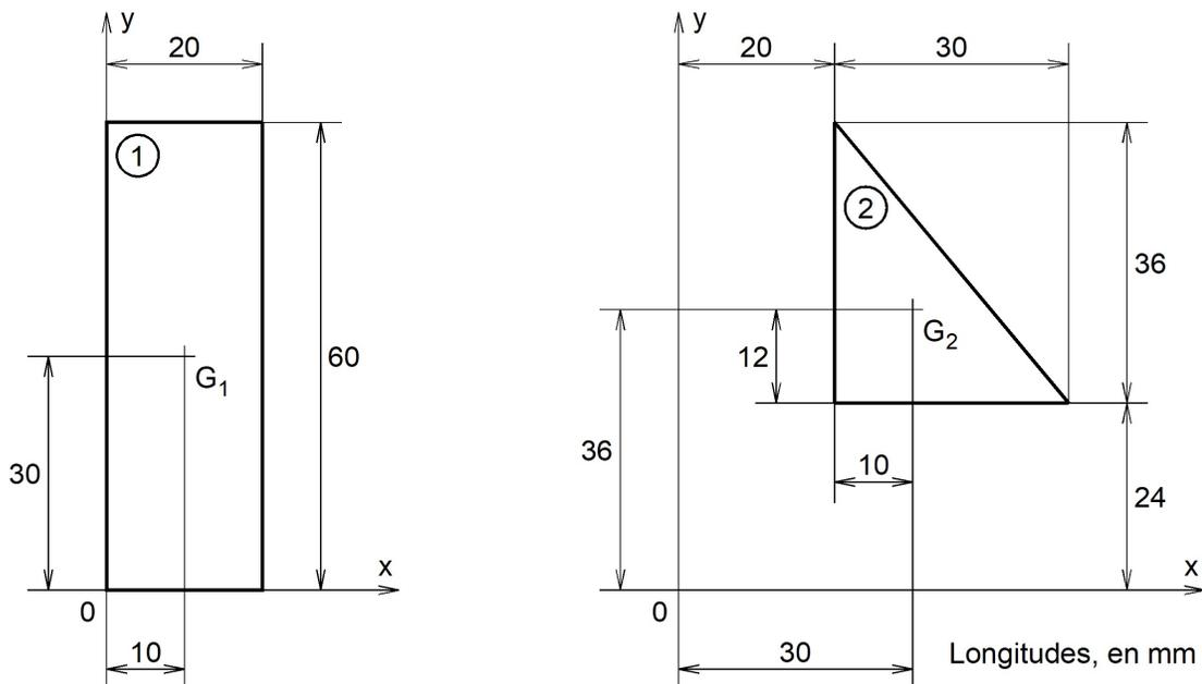
Se puede verificar que el centroide de un rectángulo se localiza en su centro, ubicado a la mitad de su base así como de su altura, y que el centro geométrico de un triángulo rectángulo está a la tercera parte del cateto horizontal medido desde el ángulo recto, y a la tercera parte del cateto vertical, también medido desde el ángulo recto.
