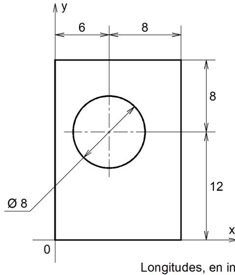
Para obtener el centro de masa de la placa de madera, el cual es el mismo que el centroide de la figura plana debido a que es homogénea y de espesor constante, se puede subdividir en dos figuras primitivas, la primera el rectángulo de 14 x 20 in, y la segunda el círculo vacío de 8 in de diámetro. Los centroides de dichas primitivas,  $G_1$  y  $G_2$ , se muestran en la siguiente figura:
