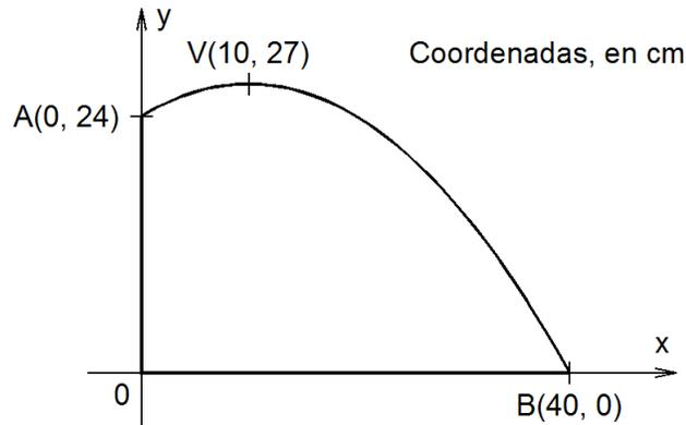
Las expresiones que se pueden emplear en este caso para el cálculo de las coordenadas del centro de gravedad,  $x_G$  e  $y_G$ , del cuerpo tabular con perfil parabólico mostrado en la figura anterior son las siguientes:
