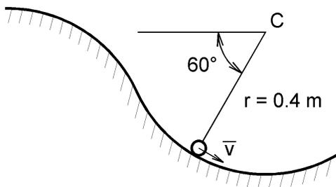
Ante todo, se dibuja el diagrama de cuerpo libre de la partícula, en una posición indicada sobre la superficie curva, en este caso debido a que se solicitan los valores cinemáticos y dinámicos en dicha posición:
