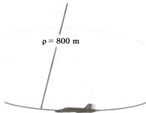
Para movimiento curvilíneo, se puede verificar que la velocidad siempre es tangente a la trayectoria.
