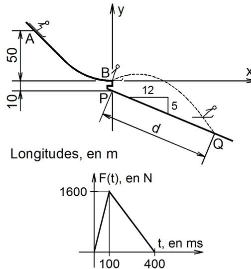
Para resolver este problema, primero se puede calcular la rapidez horizontal que adquiere el esquiador desde A hasta B, con el empleo del método del trabajo y la energía.
