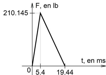
Para resolver este problema, primero se emplea el principio de impulso y cantidad de movimiento lineal, para calcular la magnitud de la velocidad inicial y, posteriormente, con base en ecuaciones de movimiento del tiro parabólico generado, establecer a qué altura pasó el balón cuando recorrió horizontalmente 50 yd.
