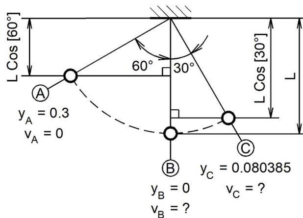
Se aplica el método del trabajo y la energía para calcular la rapidez en el punto B:
