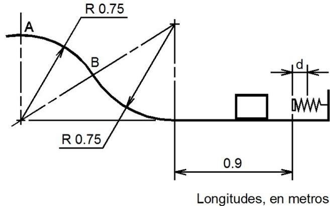
Para la resolución de este problema se aplica primero el método del trabajo y la energía, para calcular el valor de la deformación del resorte; posteriormente, las ecuaciones de movimiento para determinar la magnitud de la aceleración total del bloque en B.
