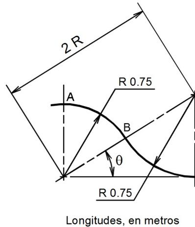
Puede calcularse el ángulo  $\theta$  con base en el triángulo rectángulo mostrado, en el cual el cateto opuesto es igual a  $R$  y la hipotenusa a  $2R$ . Por consiguiente:
