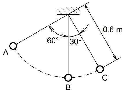
En este problema, se aplica el método del trabajo y la energía para calcular la rapidez en las posiciones indicadas y las ecuaciones de movimiento para determinar la fuerza de tensión en el hilo y la aceleración total de la partícula.
