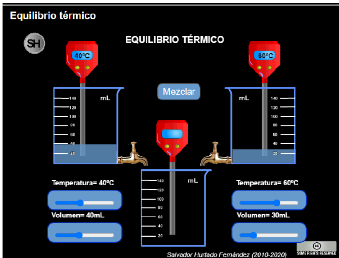
Figura 6.2. Pantalla del simulador de equilibrio térmico.
