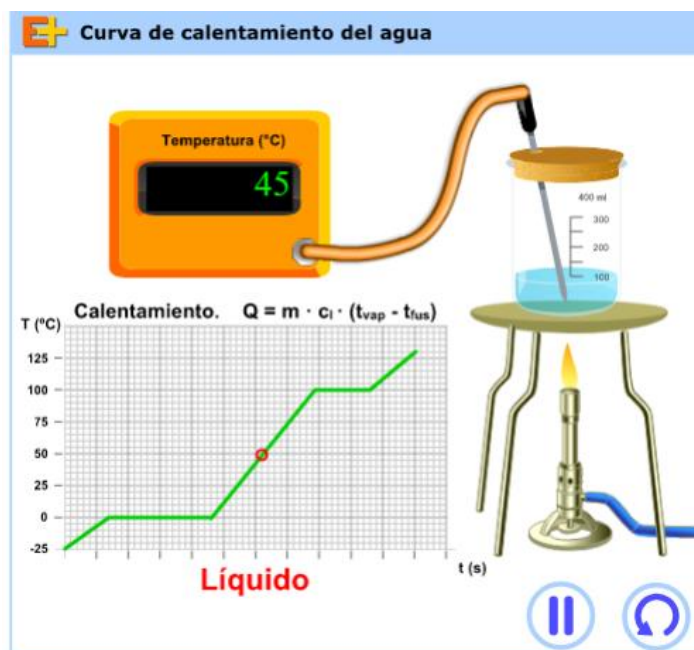
Figura 5.3. Pantalla del simulador de curva de calentamiento.
