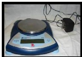
Foto 6. Balanza de 400 [g] y resolución de 0.01 [g].
