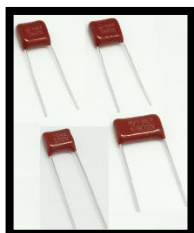
Foto 6. Capacitores de poliéster.
