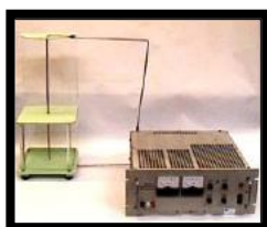
Foto 9. Conductor recto de cobre conectado a una fuente de alto voltaje (para uso del profesor).
