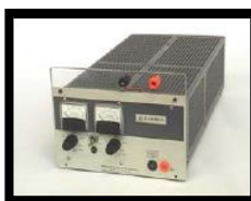
Foto 5. Fuente de poder de 0-20 [V] 0-10 [A] de cd.
