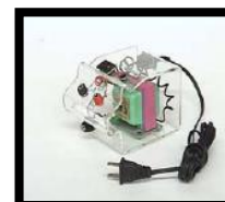
Foto 16. Transformador reductor (127 [V] a 10 [V] de c.a.).
