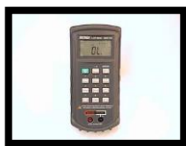
Foto 2. Puente de impedancias.
