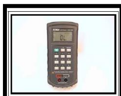
Foto 2. Puente de impedancias.
