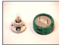
Foto 6. Foco de 6.3 [V] y capacitor de 1[F].
