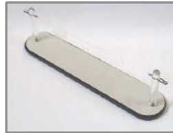
Foto 3. Soporte con alambre de nicrómel.
