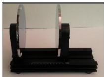
Foto 13. Capacitor de placas planas y paralelas.
