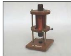
Foto 6. Solenoides de 800 vueltas y núcleo recto de acero.
