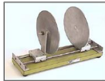
Foto 9. Capacitor de placas planas y paralelas.
