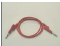
Foto 21. Cables banana- banana y cables caimán-banana.
