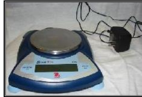
Foto 6. Balanza de 400 [g] y resolución de 0.01 [g].
