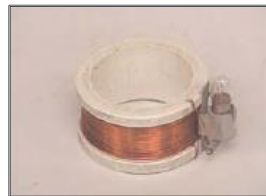
Foto 10. Bobina con foco.
