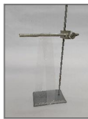
Foto 8. Soporte universal, tornillo de sujeción, varilla de aluminio y tira de polietileno.
