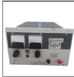
Foto 3. Fuente de diferencia de potencial continua.
