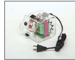
Foto 16. Transformador reductor (127 [V] a 10 [V] de c.a).
