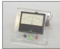
Foto 3. Micro-amperímetro de \pm 50 [ \mu A] y cero central.
