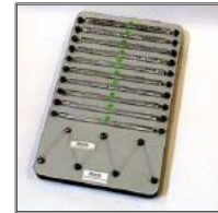
Foto 4. Tablero con diferentes muestras de alambre nicrómel.
