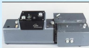
**Figura 2.** Espectrofotómetro ultravioleta Beckman, Modelo DK1
