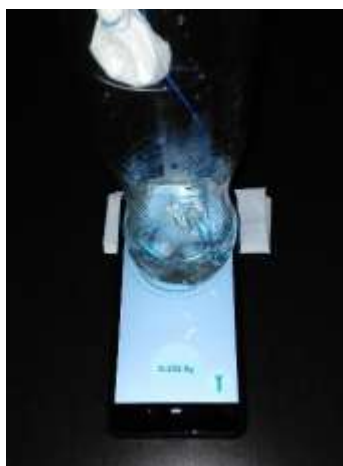
Figura 3. Medición de masa con la aplicación “WEIGHT SCALE ESTIMATOR”
