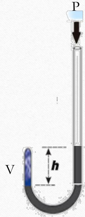
Enseguida vertió más mercurio en una rama hasta lograr un desnivel y midió la columna de aire encerrado obteniendo el nuevo volumen  $V_1$  y la nueva presión  $P_1$ . Debido a que el proceso se realiza casi estáticamente, se asume que el proceso transcurre en forma isotérmica. Después de llevar a cabo varias mediciones como las descritas anteriormente, Robert Boyle encontró que el volumen de un gas varía inversamente con la presión ejercida sobre él, si la temperatura permanece constante.
