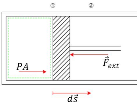
**Figura 2.** Diagrama en el que se muestra un gas que se expande, por lo que el émbolo se desplaza de la posición 1 a la 2. Obsérvese que estamos despreciando el peso del émbolo.
