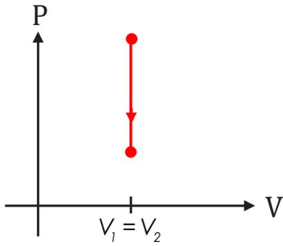
$${}_1w_2 = -\int_{V_1}^{V_2} P dV ; \text{ como } dV = 0, {}_1w_2 = 0$$
