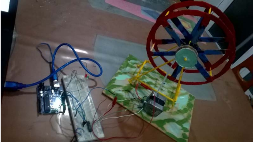
Figura 1 Fotografía de la rueda de la fortuna con la tarjeta Arduino y el circuito de control.
